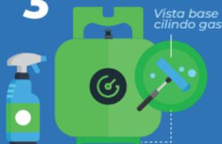
**Limpia la base** del cilindro de gas antes de colocar el sensor.
