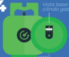
**Coloca el sensor** en el punto medio de la base. La almohadilla negra debe quedar en el punto medio. El sensor debe quedar completamente horizontal.
