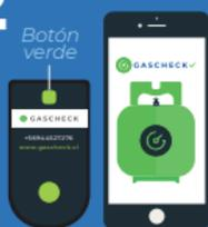
Abre la app Gascheck y sincroniza el sensor presionando **5 veces el botón verde\***. Aparecerá sensor en la App Gascheck y podrás configurarlo.
